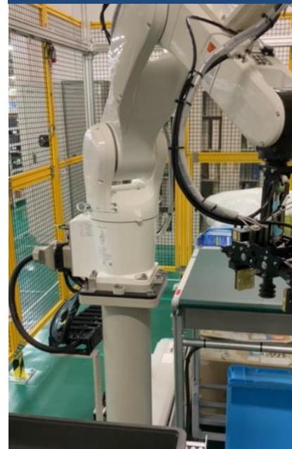
周期的にPLCに軌道を送付することでアームロボットを制御する。デッドライン違反が連続発生し、キュー枯渇時にはアームが安全停止する仕組み。軌道の生成・送付にはROSのMoveIt!を利用。
