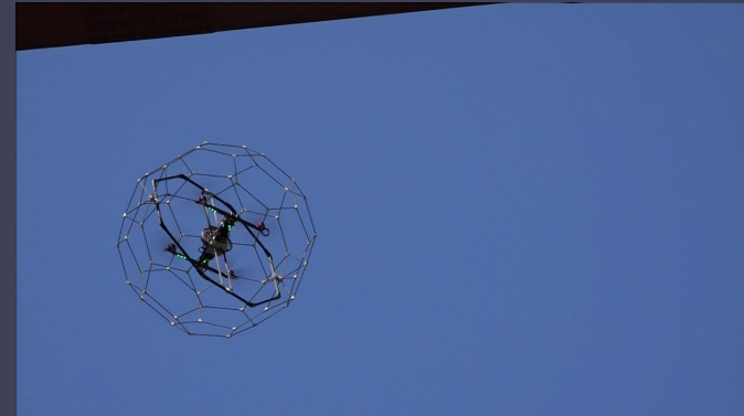
球殻ドローンによるインフラ点検 [水谷+, 2013]
