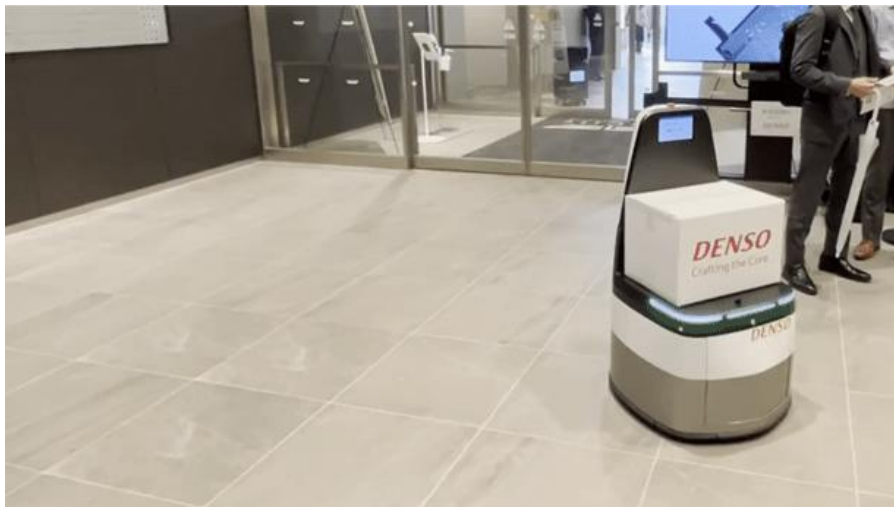
隘路（風除室）付近の経路調停の様子 手前の機体が奥の機体の占有解除を待ってから進行
